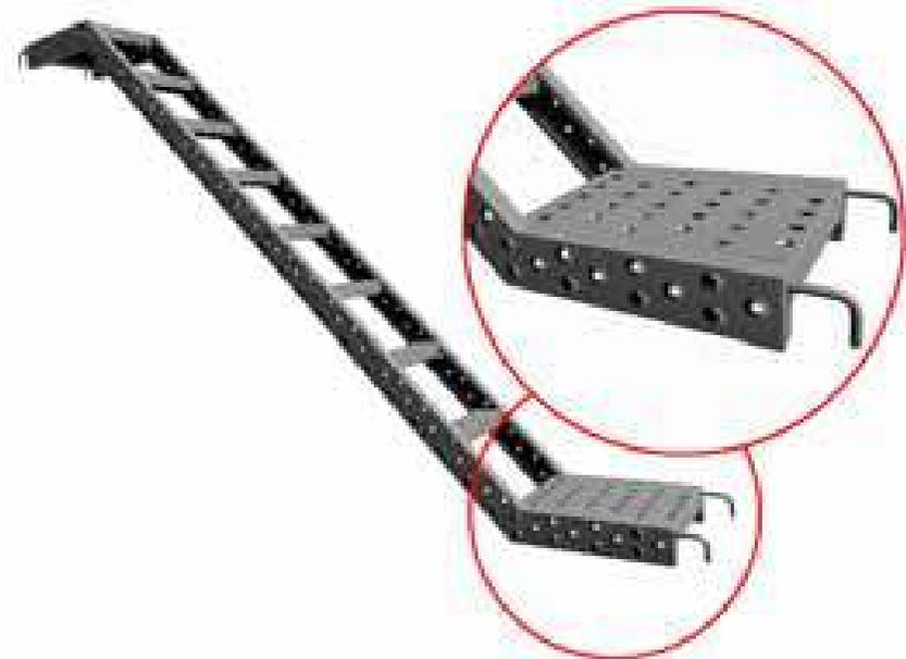
Лестница выполнена из стали 1,5мм и укреплена профильной трубой. На ступенях лестниц пробиты отверстия с пуклёвкой, что обеспечивает безопасность работы на них. Лестница устанавливается по диагонали под углом 45° на высоту 2м и крюками закрепляется за поперечные горизонталь вертикальных рам. Стальная лестница выдерживает нагрузку до 500кг.
