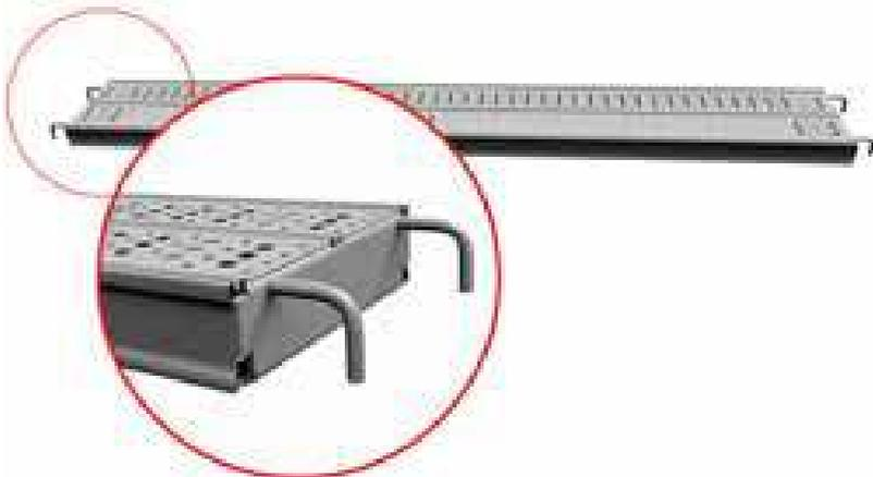
Настил выполнен из листовой стали 1,5мм и усилен каркасом из профильных штампованных элементов.
