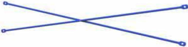
Для обеспечения жесткости лесов каждый ярус должен иметь диагональную перекрещивающуюся связку на всю высоту. По длине конструкция также должна связываться диагоналями (в каждом ярусе) на всю высоту. В конструкции лесов ЛРТ-42 применяются два связанных шарнирным соединением диагональных элемента.
